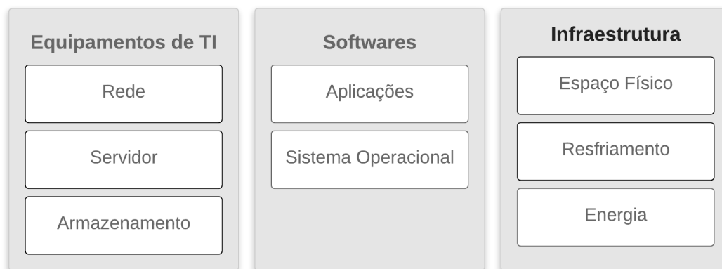
Figura 2.2: Infraestrutura típica de um Data Center
