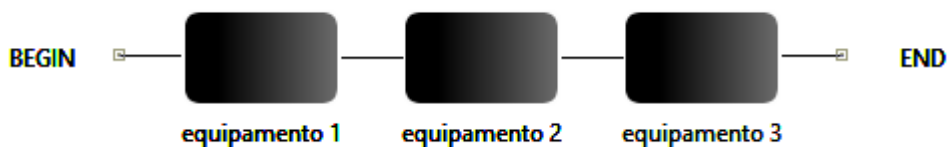
Figura 3 – Diagrama de bloco de confiabilidade – Composto por três equipamentos em série
